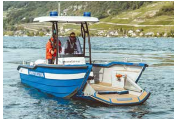
Die patentierte Bugklappe über der Wasserlinie erleichtert jegliches Retten und Bergen.
